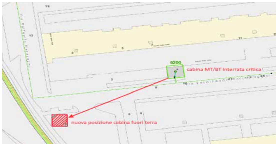
FIGURA 3 - ESEMPIO DELOCALIZZAZIONE CABINA INTERRATA
