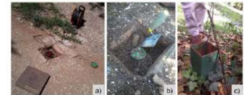
Figura 87 - Stato di conservazione di alcuni tubi sottoposti a monitoraggio. Il pozzetto F3_04 in precario stato di manutenzione (a) e interrato a seguito delle piogge di ottobre 2012 (b). Nell'immagine (c) uno dei rami rinvenuti all'interno del tubo F4_88 in data 30 ottobre 2012.
