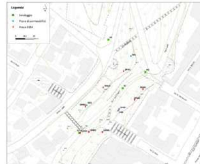
Figura 21 - Ubicazione delle prove in situ eseguite durante tutta la campagna geotecnica.
